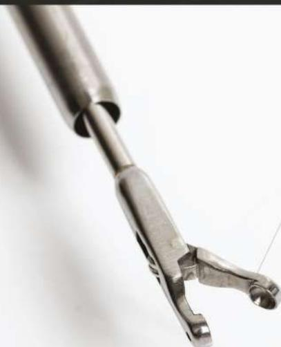
Imagem ampliada da ponta coletora
